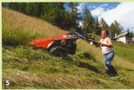
Klassische Mähmaschine mit Messerbalken: der Motormäher. Er wird auch im Berggebiet zunehmend durch die effizienteren Zweiachsmäher abgelöst, v.a. durch Kreiselmäher.
